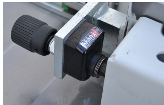
Cuffia toupie Movimentazione tramite volantini e spostamenti Visualizzati Spindle hood Linear movement by handwheels and displayed movements
