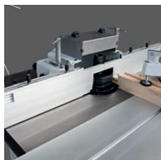
Guide in alluminio lamellari Alloy safety fence lamellar type Guides en alu pour capot type lamellaire
