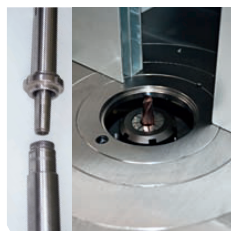
Albero MK4 e sede per mandrino MK4 spindle and housing for chuck Arbre MK4 et logement pour mandrin
