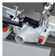
Supporto esclusione guida Support for the exclusion of the hood Support pour l'exclusion du capot
