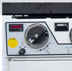
Toupie inclinabile con visore elettronico Tilting spindle with electronic readout Toupie inclinable avec viseur électronique
